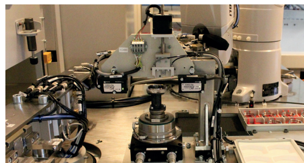
mesure de la planéité et de l'orientation du composant
